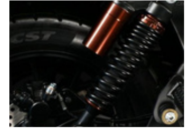
Dahili nitrojen ön yüklemeli, ayarlanabilir sönümleme
